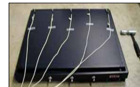
インパルスハンマ-を用いたコンプライアンステスト
