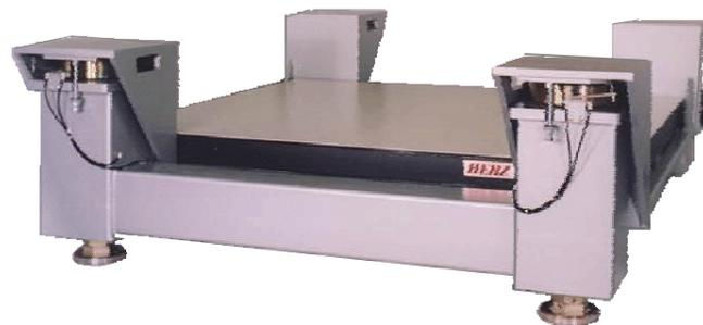
当社では、大きな高さのある精密測定機器や特殊な形状と使用法に最適な、懸垂型・超高性能三次元空気ばね式防振台を設計・製作いたします。
